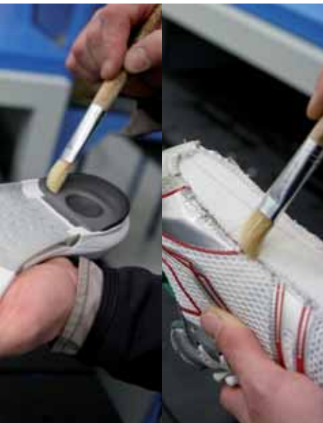
La tige et la semelle sont encollées pour l'assemblage
